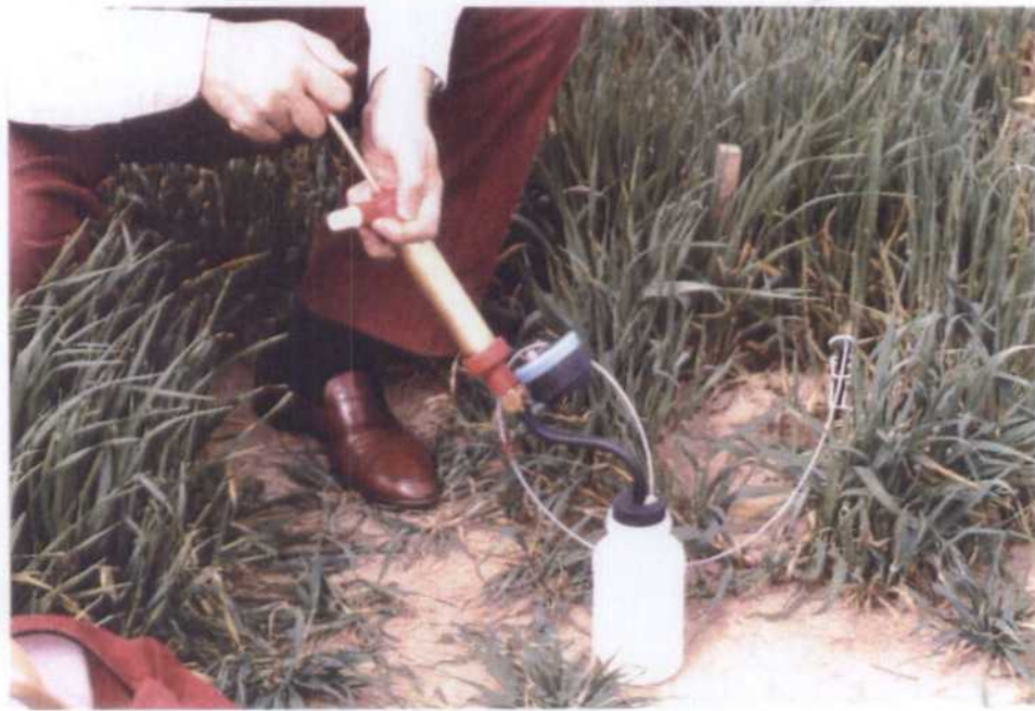
Fig. 3.9. Extracción de una muestra de agua procedente de un lisímetro de vacío.
