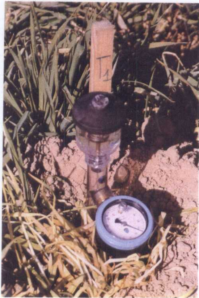
Fig. 3.5. Aspecto de un tensiómetro instalado en el campo.
