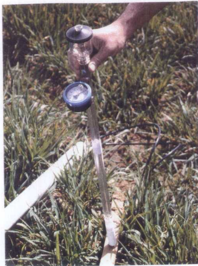
Fig. 3.4. Esquema de un tensiómetro y aspecto que presenta.
